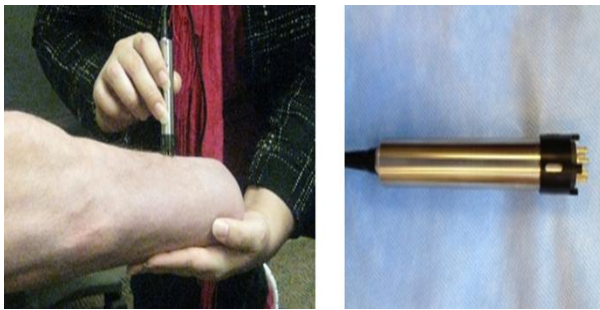
Figura 1: Sonda de SEC usada para obtener datos sobre la humedad de la piel en 5 lugares del miembro residual.
